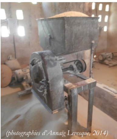
(en haut) Vannage du mélange son + semoule de sorgho au moulin (à droite) Un moulin à sorgho à moteur
