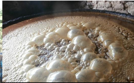
2. Le sirop avec de l'eau et de la vidange est mis à « fermenter » pendant quelques jours ( pour 1 bay de sirop il faut 60 gallons d'eau et 120 gallons de vidange ).
