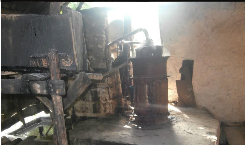
4. Le sirop fermenté est amené par bokit (=seau) dans un canal relié à la « cuve », c'est-à-dire la colonne de distillation, qui est chauffée par une chaudière alimentée au bois.
