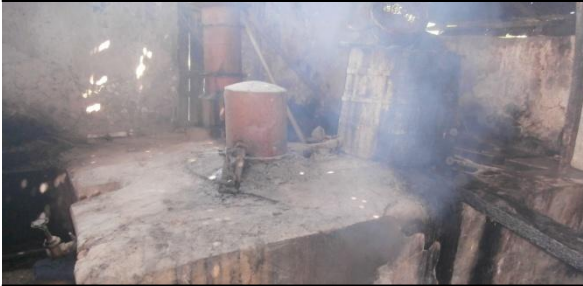
4. Le sirop fermenté est amené par bokit (=seau) dans un canal relié à la « cuve », c'est-à-dire la colonne de distillation, qui est chauffée par une chaudière alimentée au bois.
