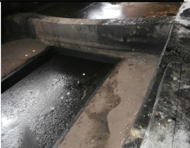
3. Après extraction le jus est mis en bassin ; il y est stocké plusieurs heures.
